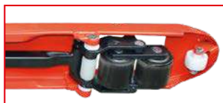
Polyurethan-Tandemrollen Ø 80 mm und Kletterrollen vor und hinter den Tandemrollen.
