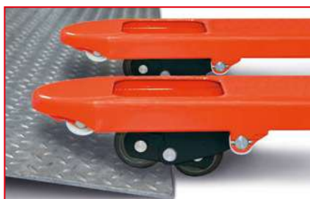
Polyurethan-Tandemrollen Ø 80 mm und Kletterrollen vor und hinter den Tandemrollen.
